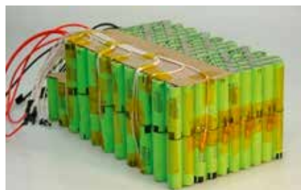
Obrázek č. 3: Neschopnost vyrobit článek NMC o vyšší kapacitě se nahrazuje jejich vzájemným propojováním do obrovských celků. Dokážete si představit, že vyměníte jeden vadný článek ze středu svazence?
