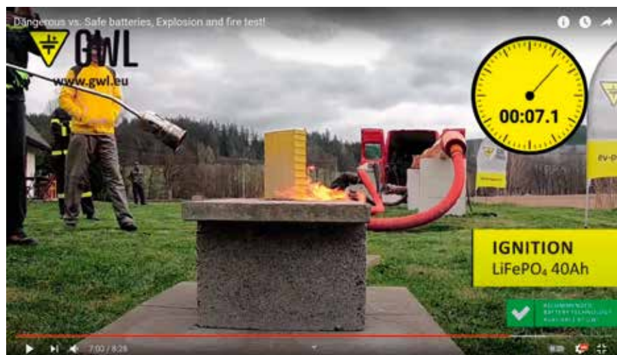
Obrázek 7: Zde se v GWL pokoušíme zapálit LFP článek.
